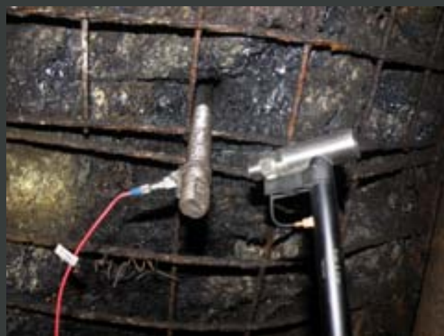
Wymuszenie żerdzi kotwionej z wykorzystaniem młotka modalnego
