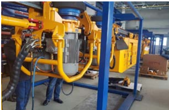
Napęd elektryczny ciągnika kolejki podwieszanej
