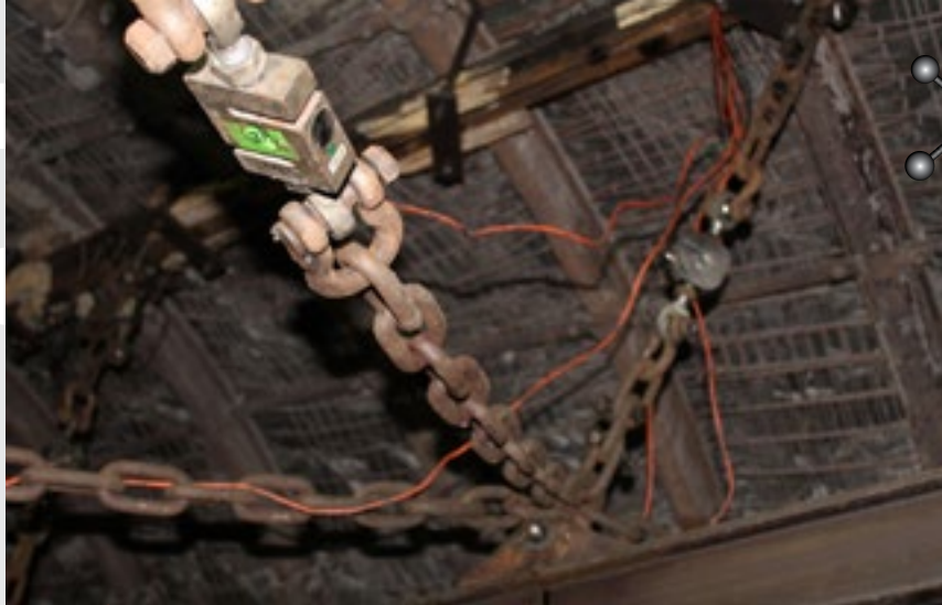
Siłomierze zabudowane w łańcuchu zawiesi i łańcuchu odciągu.
