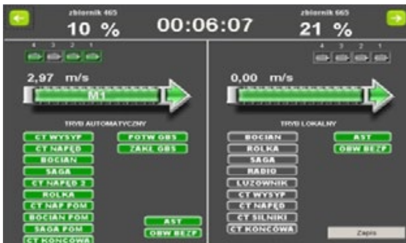
Rys. 2 Podgląd stanu pracy przenośnika, parametrów poszczególnych głośników oraz wartości napięć na poszczególnych urządzeniach systemu Promos.
