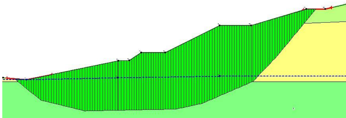
Rys. 4.75. Powierzchnia poślizgu dla skarp 2-5, przekrój I 1 -I 1 ' – metoda Felleniusa
