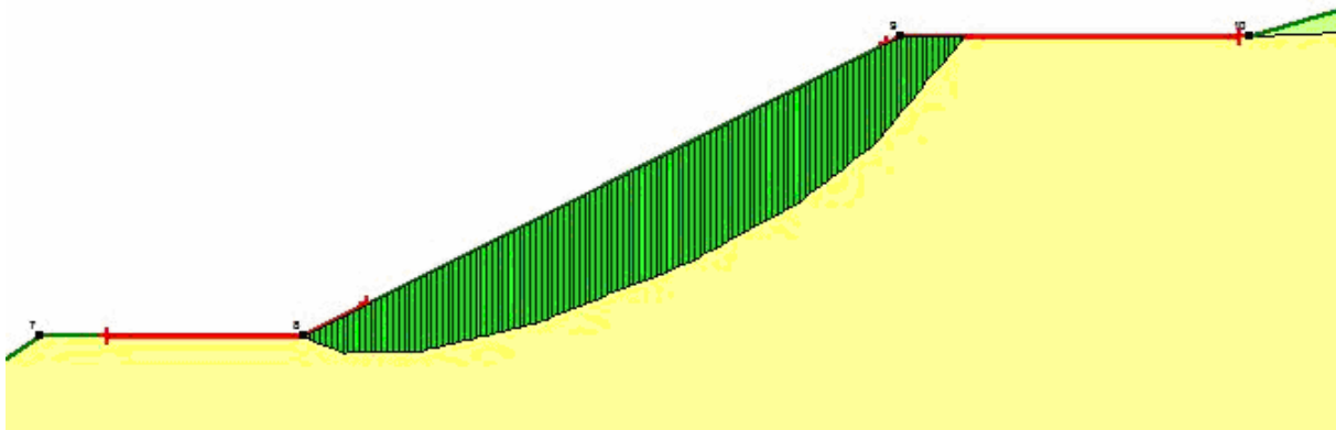
Rys. 4.64. Powierzchnia poślizgu dla 3 skarpy, przekrój I 1 -I 1 ' – metoda Janbu
