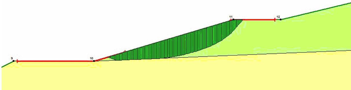
Rys. 4.63. Powierzchnia poślizgu dla 2 skarpy, przekrój I 1 -I 1 ' – metoda Janbu
