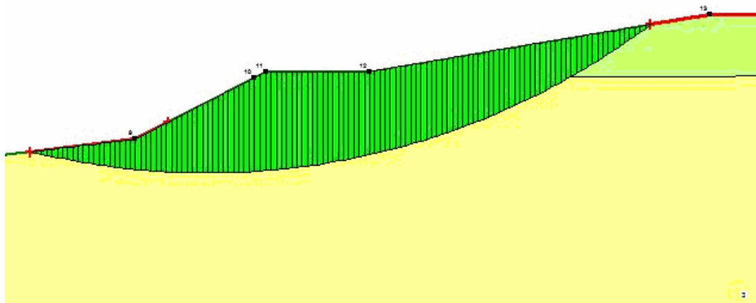
Rys. 4.46. Powierzchnia poślizgu dla skarp 2-3, przekrój F_1-F_1' – metoda Janbu
