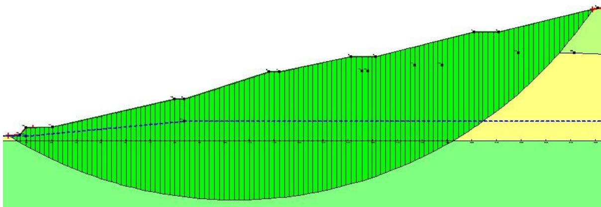
Rys. 4.37. Głęboka powierzchnia poślizgu, przekrój E1-E1` – metoda Felleniusa
