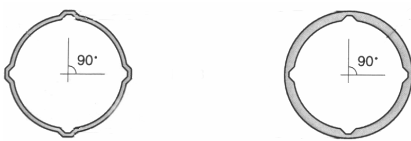
Rys. 4.89. Typowe przekroje rur inklinometrycznych
