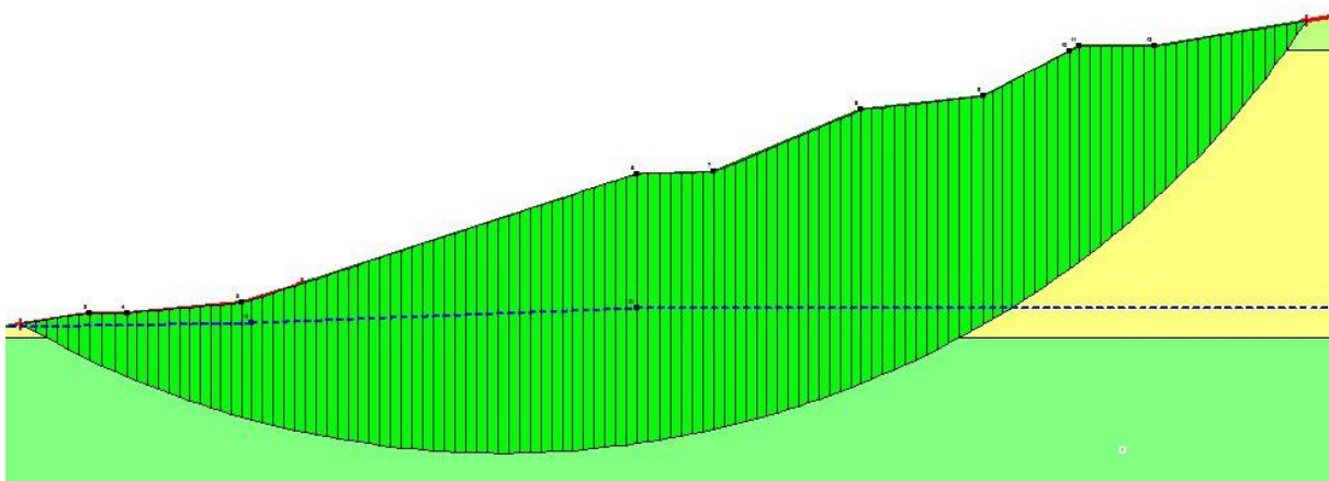
Rys. 4.53. Powierzchnia poślizgu dla skarp 2-5, przekrój F_1-F_1' – metoda Felleniusa
