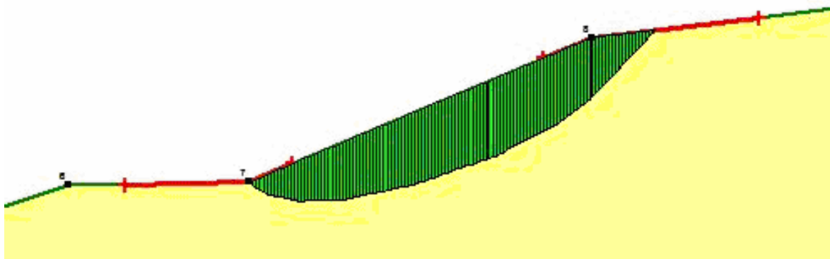
Rys. 4.43. Powierzchnia poślizgu dla 4 skarpy, przekrój F_1-F_1' – metoda Janbu
