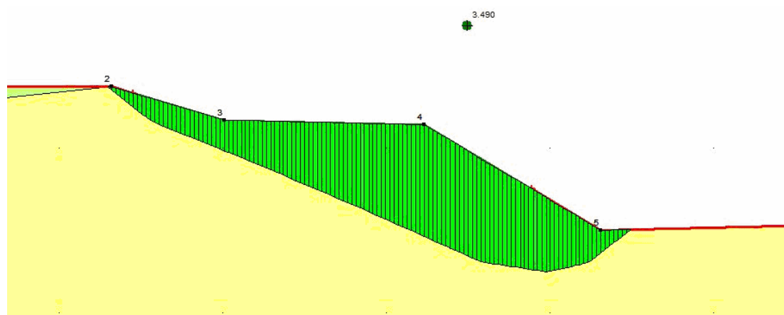
Rys. 4.11. Powierzchnia poślizgu dla skarp 1-2, przekrój D 1 -D 1 ', model z obciążeniem – metoda Felleniusa
