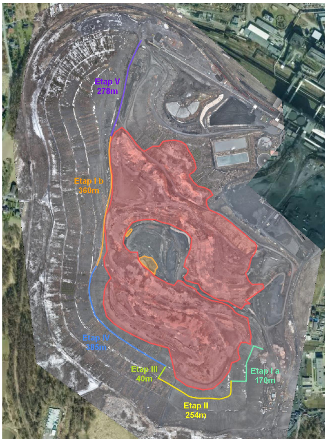
Rys. 5.22. Proponowana lokalizacja ekranów termoizolacyjnych na hałdzie Marcel
