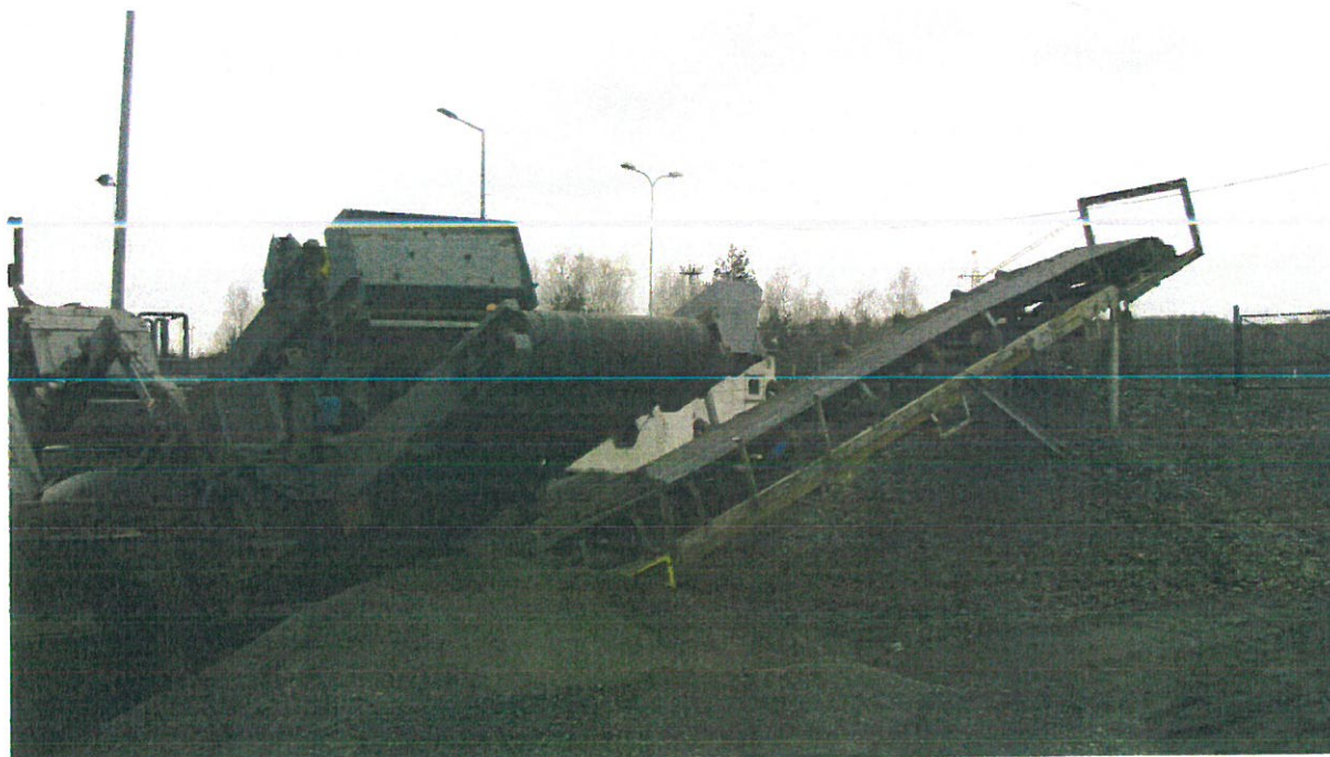
Fot. 2 . Instalacja do przetwarzania odpadów wydobywczych na kruszywo.
