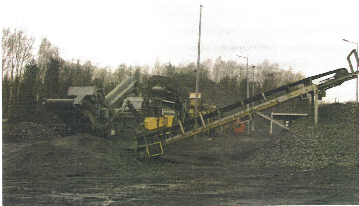
Fot. 1. Instalacja do przetwarzania odpadów wydobywczych na kruszywo.
