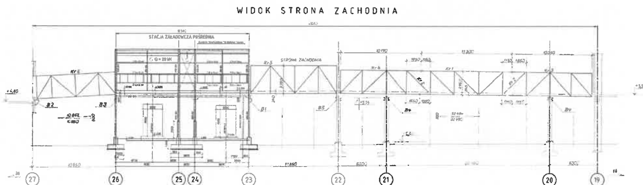
Rys nr 1. Widok strona zachodnia pomostu technologicznego 706, 232 wraz ze stacją pośrednią.
